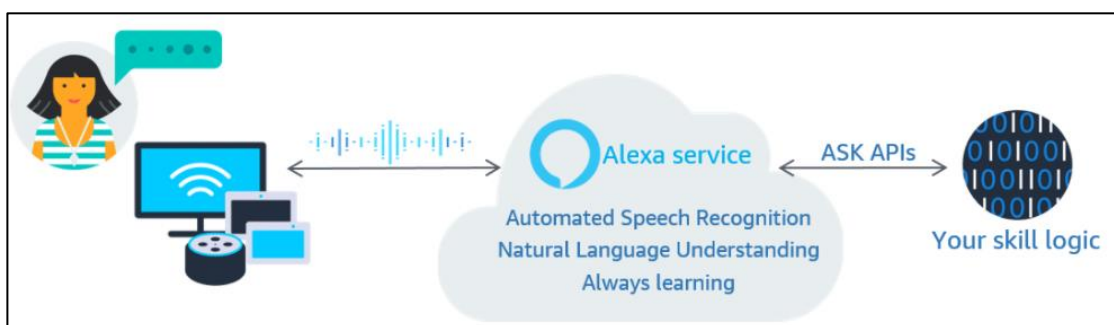
Figura 15. Diagrama del proceso de invocación de una skill [10]
