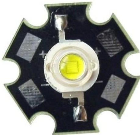
**Figura 3.20: Leds de potencia**
