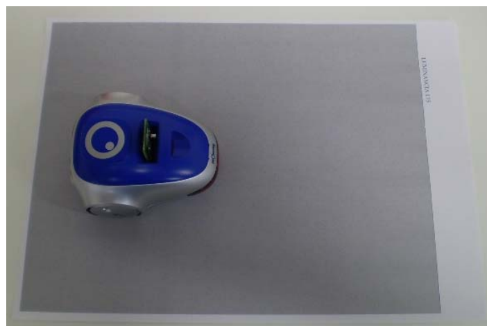
Figura 37: Prueba sensores de línea, luminancia 175
