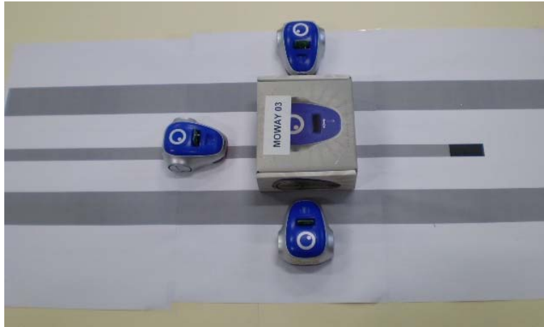
Figura 51: Guiado de un objeto por un camino utilizando líneas
