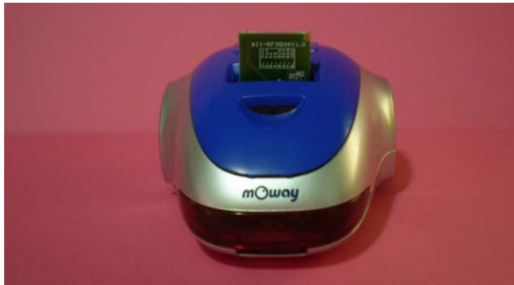
Figura 6: El sensor de luz se encuentra en la apertura con forma de media luna
