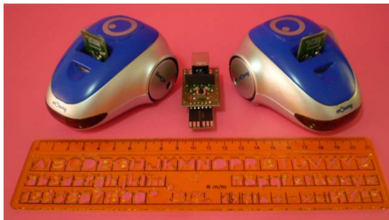
Figura 1: 2 Moways con sus tarjetas de radiofrecuencia y su base
