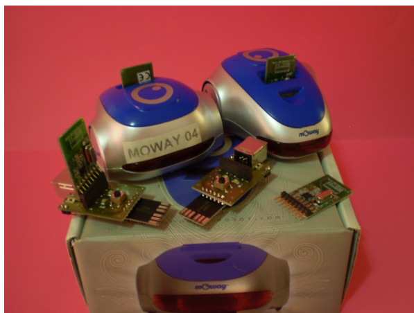
Figura 28: Robots y Bases Moway con sus tarjetas de comunicación
