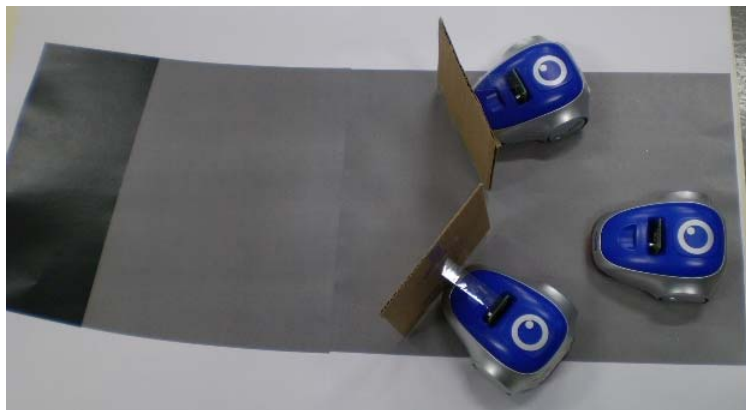
Figura 50: Guiado de un objeto por un camino, los robots laterales aparecen con lo acople empleados
