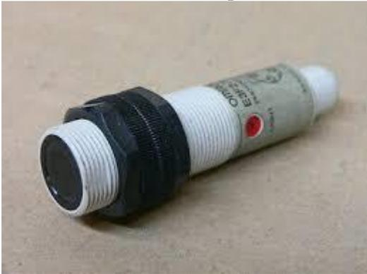
Ilustración 42 Fotocélula receptora
