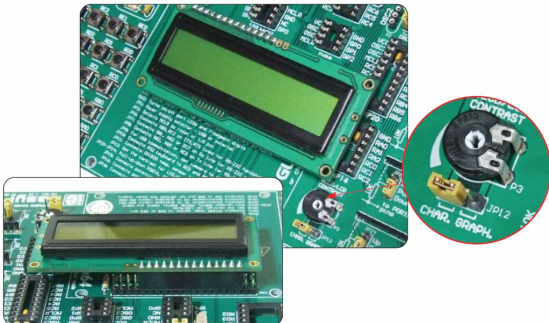
**Figura 3.20:** LCD 2x16 en modo de 8 bits
