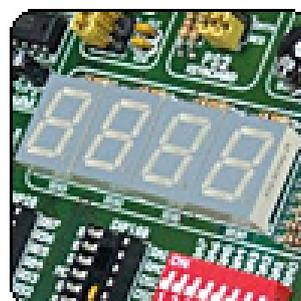
**Figura 3.18:** Displays de 7 segmentos
