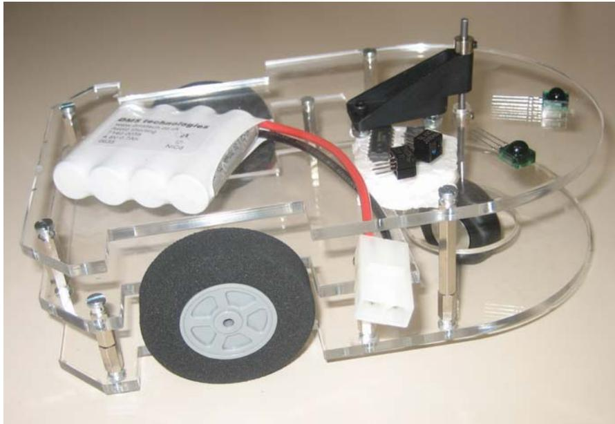
**Figura 9.1:** Microbot con estructura abierta
