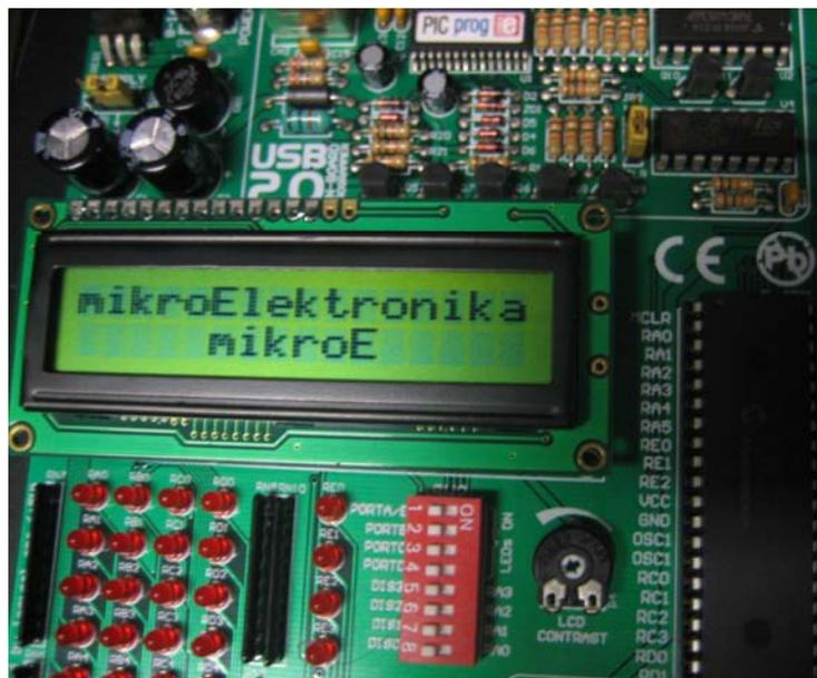
**Figura 5.8:** Imagen del LCD tras grabar el programa Lcd\_Test.
