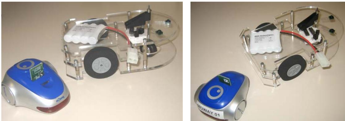
**Figura 9.2:** Robot móvil Moway y Microbot con estructura abierta
