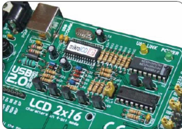
**Figura 3.11:** Programador USB integrado con mikroCD
