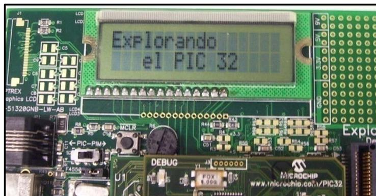
Figura 5.10: Módulo LCD de la placa Explorer16.
