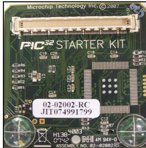
Figura 4.4: Conector para expansión modular de 120 pins y/o alimentación de la tarjeta.
