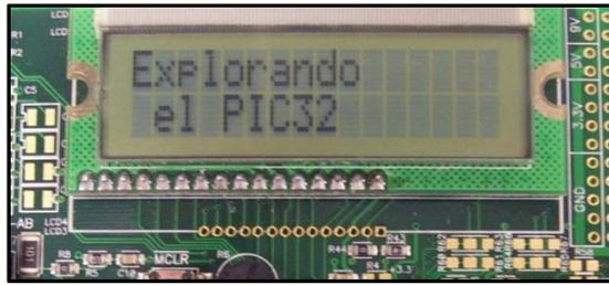
**Figura 5.31:** Programa "*LCDtest.c*" ejecutado en la Explorer16.
