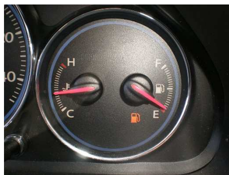
Figura 9. Medidores de temperatura de aceite y nivel de combustible
