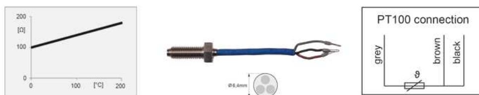
Figura 26. Esquema Pt100. Con tres cables se tendría una BUENA precisión, los modelos de cuatro cables sin embargo, ostentan la precisión óptima
