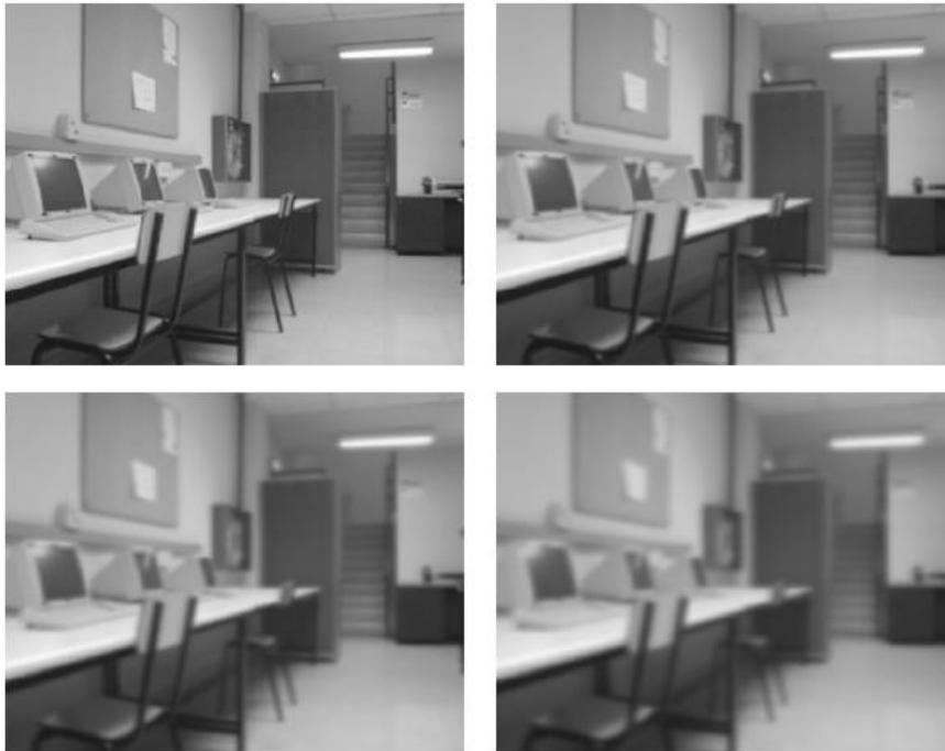
*Figura 3.4: (De izda. a dcha. y de arriba abajo) imagen con filtrado gaussiano con valores de  $\sigma=1,2,3,4$ .*
