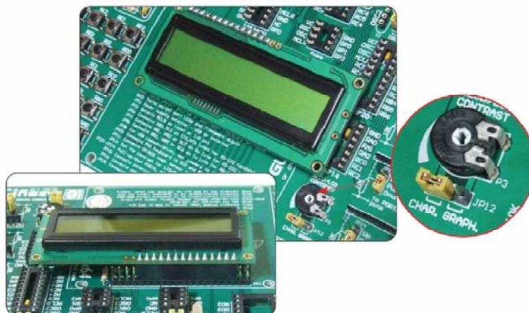
**Figura 4. 20 : LCD 2X16 en modo 8 bits**
